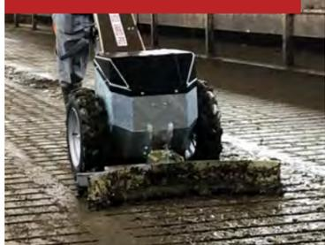
Lorsque vous faites avancer le SPR 906 Vario ou SPR 910 Vario Pro sur le sol à caillebotis, vous poussez le purin au moyen du nouveau double racler en Vulkollan, résistant et durable, à travers les fentes, dans le canal à déjections.
