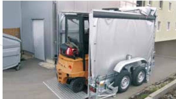
Le Miniliner permet le coulissement du toit et des panneaux latéraux vers l'avant
