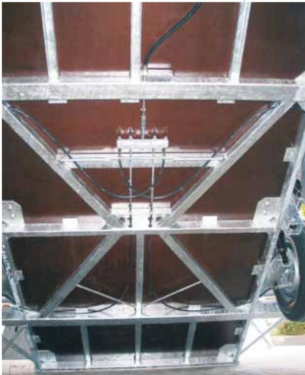
Châssis PT35 revêtu d'un plancher bois multicouche
