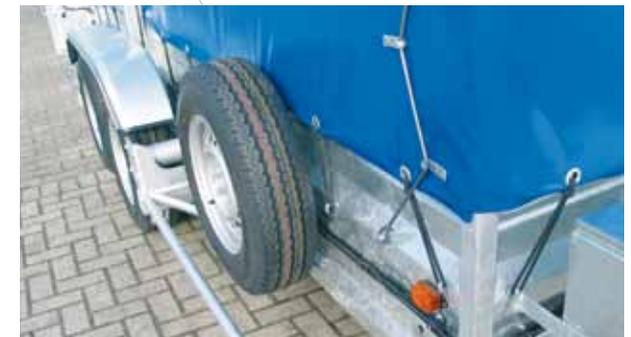
Roue de secours avec fixation
