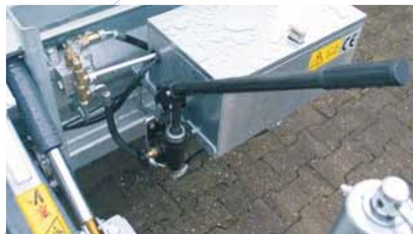
Pompe hydro-électrique avec sa pompe manuelle de secours
