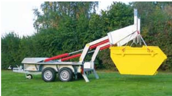
Remorque pour dépose d'une benne
