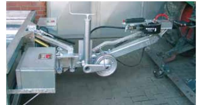
Timon réglable en hauteur avec anneau DIN et roue jockey renforcée
