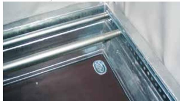
Rail perforé avec barre de fret télescopique et anneau d'arrimage au sol
