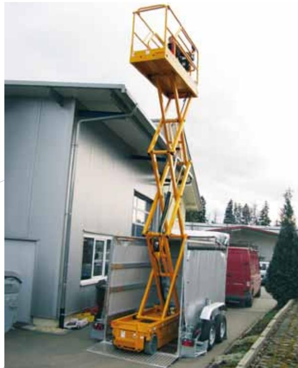
Grâce au coulissement de la bâche du toit, une nacelle peut être utilisée sans déchargement.
