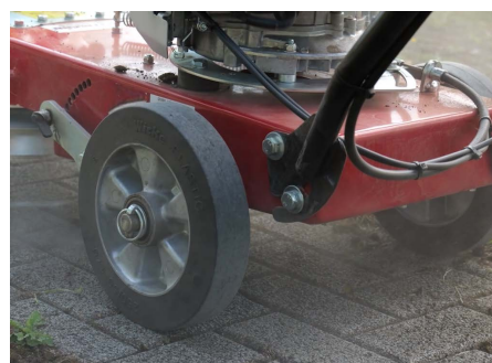
Les roues sont composées d'une jante en aluminium sur laquelle est directement collé un pneu en caoutchouc de haute qualité. Excellentes caractéristiques de roulement.
