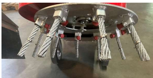
10 tresses métalliques interchangeables grâce à une fermeture à changement rapide
