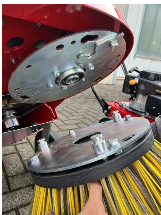
Système de changement rapide pour les tresses d'acier sur les brosses à plaques
