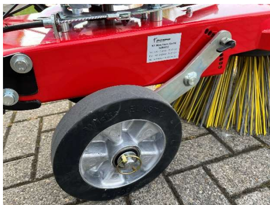
Réglage du châssis par système de boulon de verrouillage
