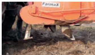
Profondeur de rotoculture jusqu'à 45 cm
