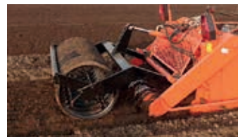
Option : Deuxième rouleau pour un lit de semis plus ferme
