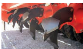
Les lames à bêcher sont fixées avec des boulons à cisaillement
